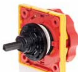
Sezionatore da retroquadro, attacco rapido, fissaggio foro 22mm, IP65, manopola lucchettabile Z33 rossa, completo di protezione per morsetti, codice NLT16/3ZM/Z33
